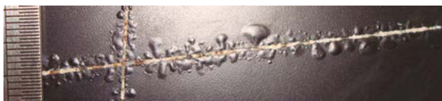
Figura 9: Destaque do comportamento de corte realizado sobre revestimento. Estado após 120 horas de ensaio “Scab in Door”, material B.
