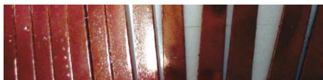
Figura 4: Estado de amostra após 72 horas de ensaio ABNT NBR 8095
