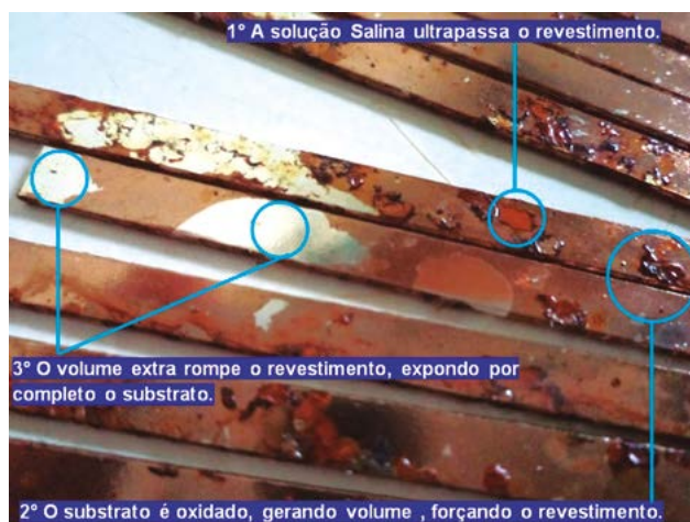
Figura 5: Estado de amostra após 72 horas de ensaio SAE J2334
